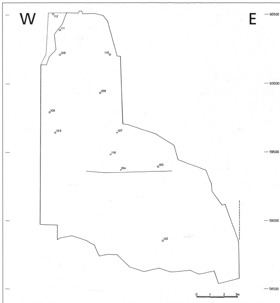
16: Façade sud, dessin du pourtour. Les points numérotés marquent la situation des trous de boulin, le trait horizontal le décrochement du mur.
